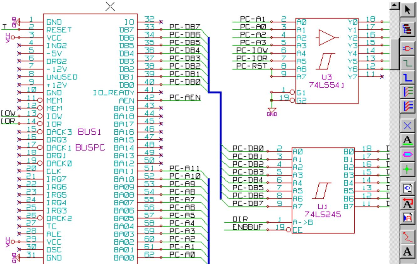
De nombreuses pins (composants U1 et BUS1 en particulier) sont connectées à des bus.
