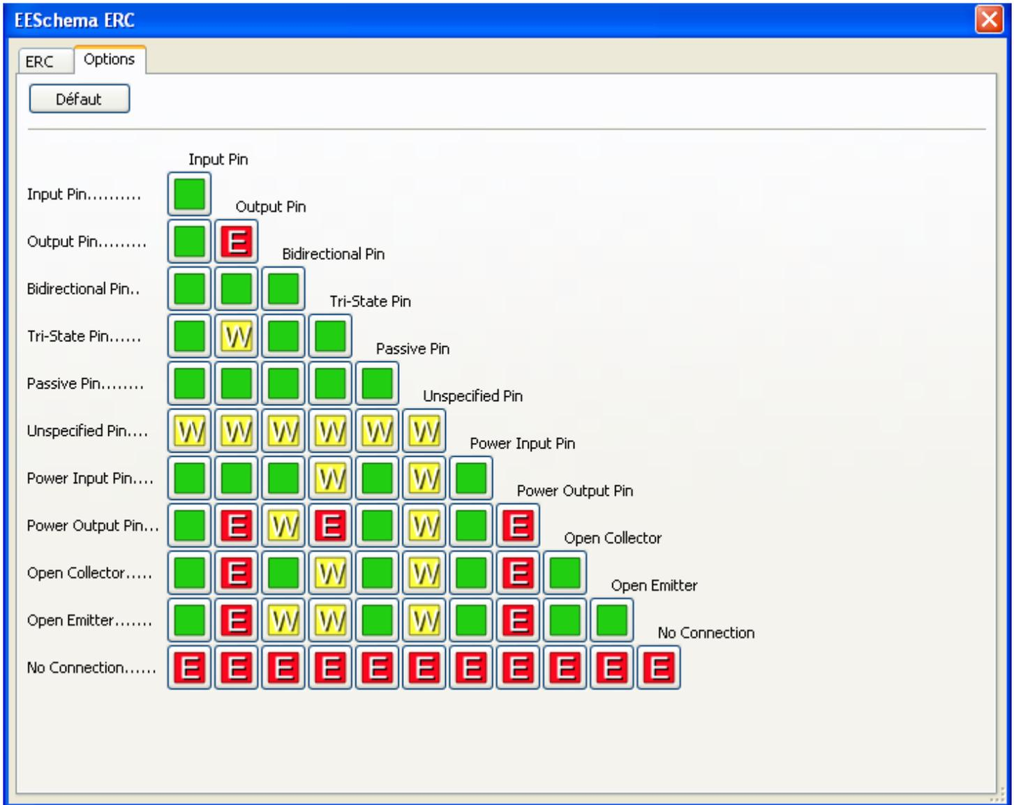
Pour chaque cas de connexion sur la matrice de définition des erreurs, on peut définir une connexion comme « normale », « warning » ou « errer), en cliquant une ou plusieurs fois sur le bouton correspondant au cas particulier de connexion.
