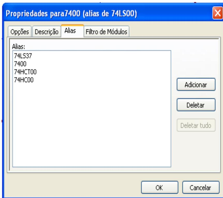
É possível assim adicionar ou apagar quaisquer alias desejados. Evidentemente, o alias atual não pode ser apagado, pois está sendo editado. Para apagar todos os alias, primeiro tem que selecionar o componente raiz (primeiro componente da lista de alias na janela de seleção da barra de ferramentas principal).
