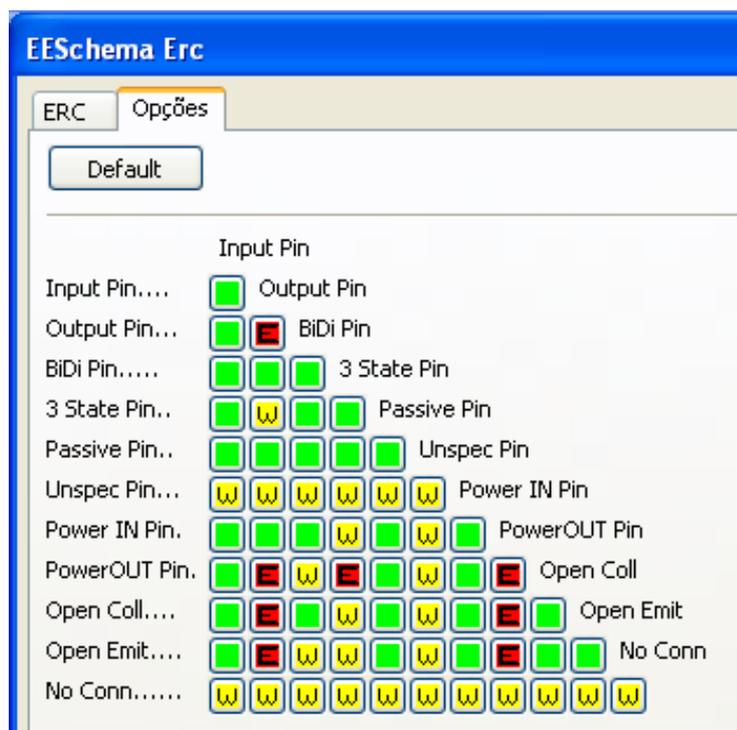
Para cada caso de conexão na matriz de definição de erros, se pode definir uma conexão como "normal" (quadro vazio), "aviso" (warning) ou "Erro", clicando uma ou várias vezes no botão correspondente ao caso particular de conexão.
