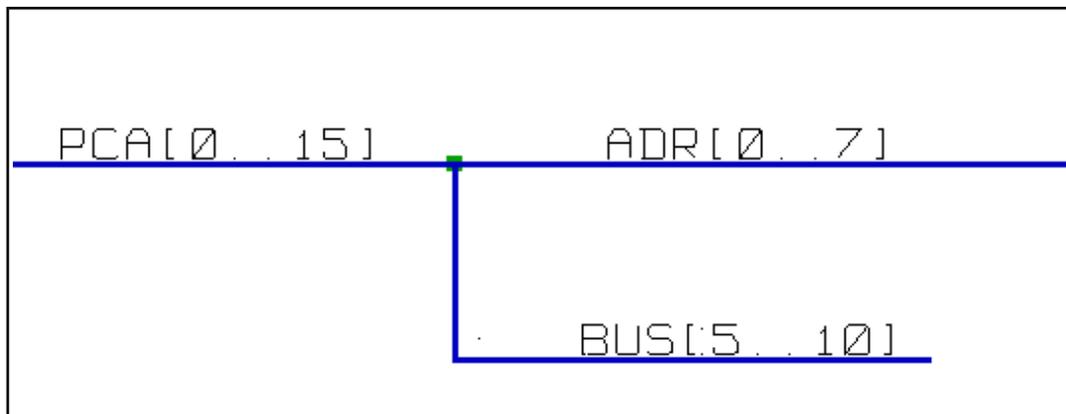
Os barramentos PCA[0..15], ADRL[0..7] e BUS[5..10] estão conectados (note que existe conexão já que a linha do barramento vertical se conecta no meio do segmento do
