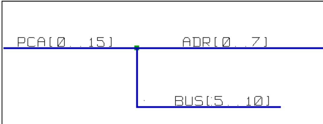
Les bus PCA[0..15], ADRL[0..7] et BUS[5..10] sont connectés ( remarquer ici la jonction puisque le fil de bus vertical arrive au milieu du segment bus horizontal).
